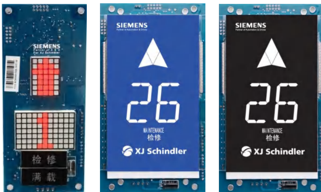
图 3-3-6-2 轿厢显示电脑板类标配 SCH5600-02J
